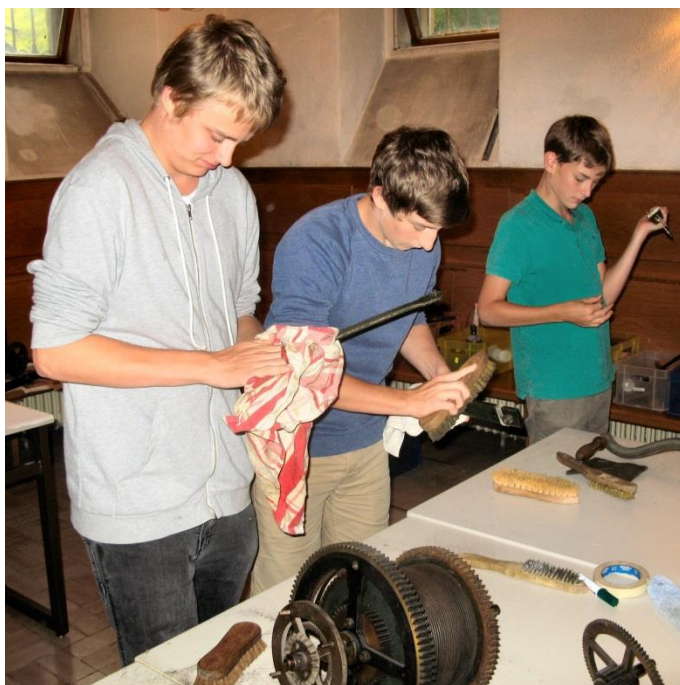
Das Putzen der vielen Einzelteile erfolgte ausschließlich mechanisch mit Bürsten, die dabei einige Borsten verloren (Foto: E. Willau).
