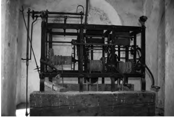
Abbildung 7: Das Turmuhrwerk der Stiftskirche Mattsee wurde in Zweitverwendung im 1766/67 errichteten „Goliath des Mattigtals“ eingebaut und vermutlich vorher umgebaut. Auch seine Teilwerke stehen noch hintereinander! (Foto: Neureiter)
