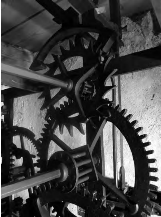
Abbildung 4: Das Hakenrad mit Anker des Turmuhrwerks Zellhof (nach der Restaurierung). Am Zwischenrad sind die Körnungen der Teilung des Zahnkranzes gut zu sehen, nach denen die Zähne gefeilt wurden. (Foto: Neureiter)
