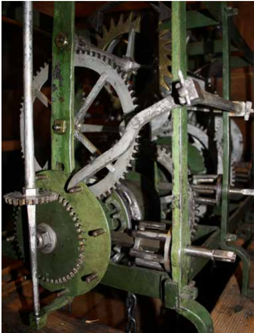
Abb.10 Detail des Gehwerks
