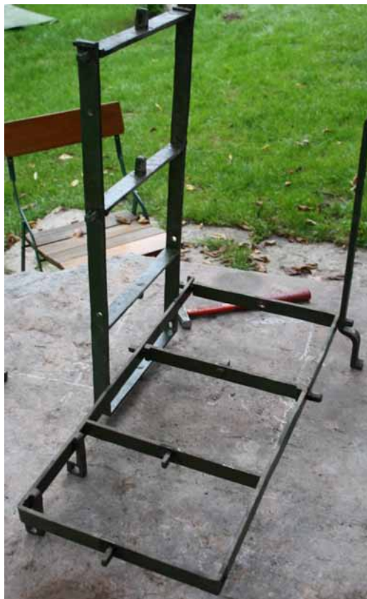
Abb. 6 Der untere horizontale Kranz und der obere Kranz (im Bild stehend) sind jeweils nur an der gehwerksseitigen Schmalseite (hinten bzw. oben) offen. Auffällig ist auch, dass die Innenbügel der beiden Kränze jeweils an der Stundenschlagwerksseite fix vernietet sind!
