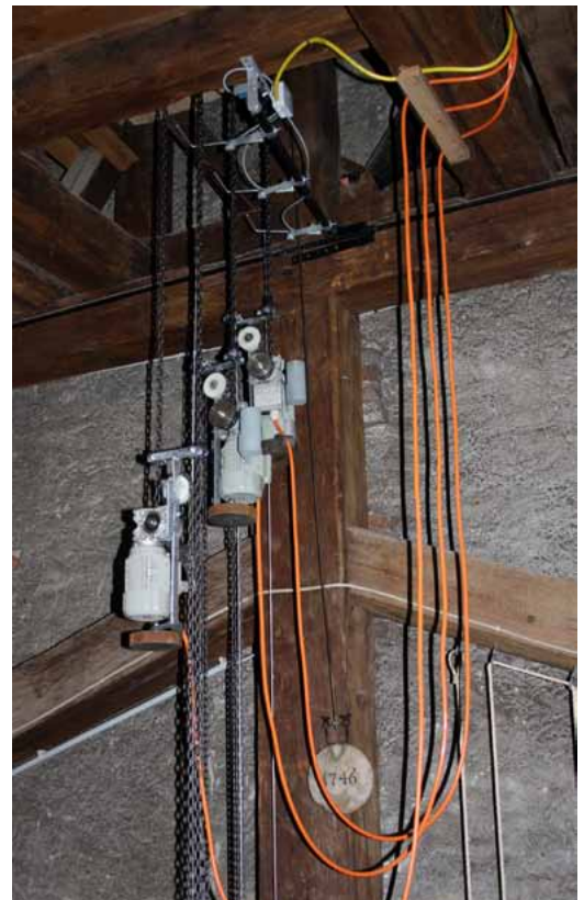
Abb. 5 Die Motoren der Elektroaufzüge dienen nun nach dem Patent von Klaus Meinhardt, Golling, als Gewichte
