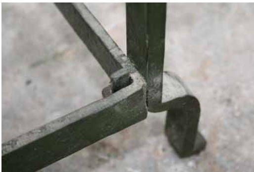
Abb. 8 Der untere horizontale Kranz ist wie der obere auf der Seite des Stundenschlagwerks durchgehend und geschlossen. Auf der Gehwerksseite gibt es zwei extra verkeilte Bügel.
