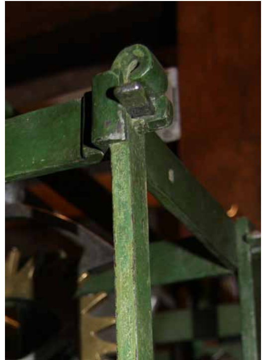
Abb. 9 Das sehr einfache Rollwerk an einer der vorderen Ecksäulen des Werks, der obere horizontale Rahmen ist auf der Gehwerks-Seite nicht durchgehend/geschlossen!
