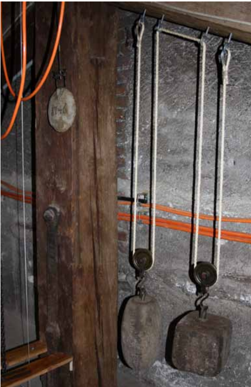
Abb. 4 Von den drei Gewichten für Gehwerk, Viertelstundenschlagwerk und Stundenschlagwerk sind zwei Steingewichte erhalten, sie wurden nun – außer Funktion – nahe dem Uhrwerk angebracht
