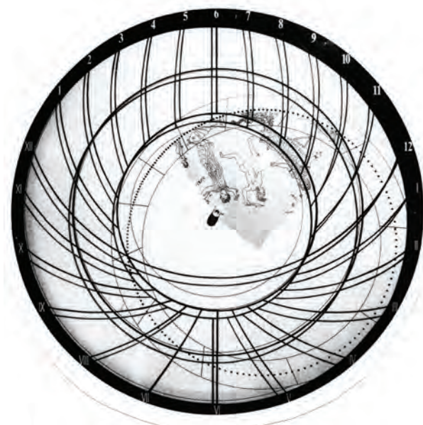
Im Bild der vorgesetzte fixe Gitterraster, dahinter die exzentrisch auf der Achse befestigte Bronzescheibe: Mithilfe des Rasters und der (kompletten) Bronzescheibe, die in 24 Stunden eine volle Umdrehung absolvierte, konnte die Ablesung erfolgen. (Bild: Salzburg Museum)
