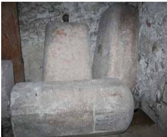
↑ ↑ ↑ Im Bild das Stiftenrad des Werks der Pfarrkirche Oberalm ↑ ↑ Die Schlossscheibe des Turmuhrwerks der Pfarrkirche Oberalm ↑ Die drei steinernen Gewichte des Turmuhrwerks der Pfarrkirche Oberalm, das vorne liegende trägt die Jahreszahl «1914»
