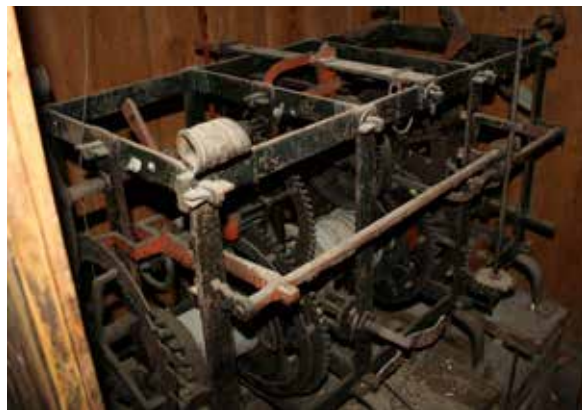
Das 1793 umgebaute Turmuhrwerk von St. Jakob am Thurn
